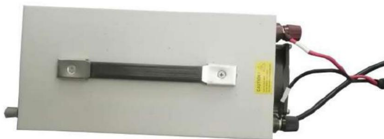
(Strømforsyning koblet til såmaskinens strømkabel)
